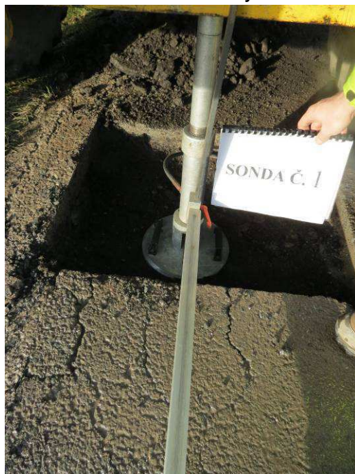
měření konstrukční vrstvy
