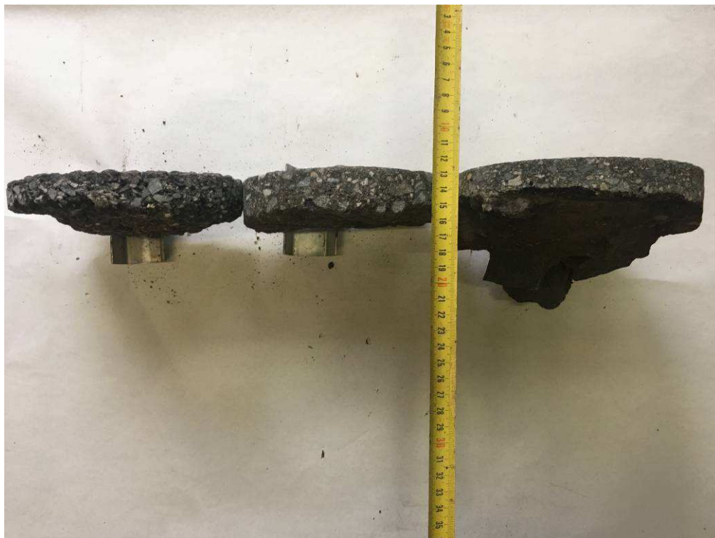
Obr. A.2 Sonda č. V4 ( km 0,785), sonda č.V5 (km 0,630), sonda č.V6 (km 0,330)
