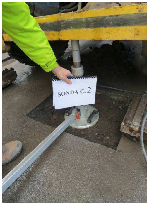
měření konstrukční vrstvy
